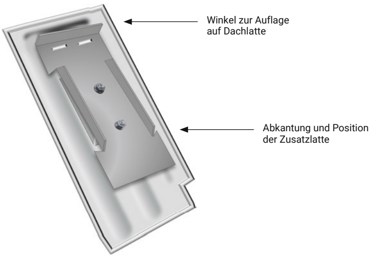
Abb. 2: Schematische Darstellung der Unterseite
