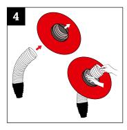
Führen Sie den Entlüftungsschlauch durch die Unterspannbahn-Dichtmanschette.
