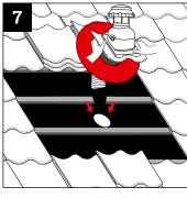
Führen Sie den Entlüftungsschlauch durch das ausgeschnittene Loch der Unterspannbahn.
