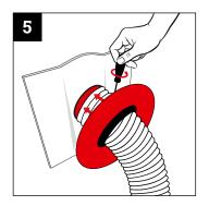
Befestigen Sie den Entlüftungsschlauch an der Lüfterpfanne.
