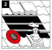
Zeichnen Sie den kreisförmigen Durchmesser des Entlüftungsschlauches auf der Unterspannbahn an.
