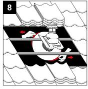
Entfernen Sie schrittweise die auf der Rückseite angebrachte Schutzfolie der Unterspannbahn-Dichtmanschette und verkleben Sie diese anschließend mit der Unterspannbahn (s. Abb. 9).
