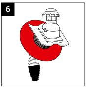
So sieht die fertige Kombination aus Lüfterpfanne und Unterspannbahn-Dichtmanschette vor dem finalen Einbau aus.
