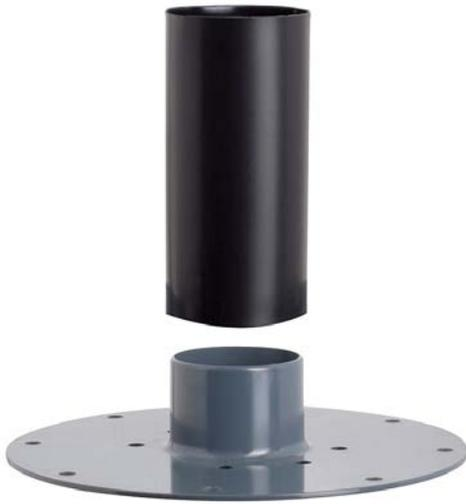
Der Schrumpfi Flachdach-Allzweck-Durchgang von FLECK eignet sich für runde und eckige Einzeldurchführungen z. B. von Kabeln oder Leitungen. Beim Erhitzen mit einem Heißluftgerät zieht sich der von innen mit Schmelzkleber beschichtete Schrumpfschlauch zusammen und der Schmelzkleber sorgt nach fachgerecht ausgeführter Schrumpfung (immer von unten nach oben) für eine dauerhafte, wasserdichte Verbindung.
