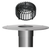
Im Bild: Flansch aus PP (Polypropylen), geeignet für das fachgerechte Anschweißen von PP-basierten TPO- und FPO-Dachbahnen
