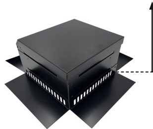
ReDro-Box: Schutzvorrichtung für die Retentionsdrossel, aufklappbar und in der Höhe in Stufen von 50 oder 100 mm beliebig aufstockbar
