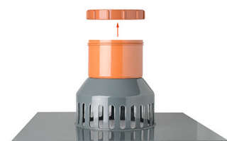
Groendakafvoerput: schroefdeksel voor visuele controle en reiniging van de afvoer. Flens van robuust hard PVC
