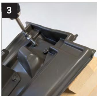
3 Sicherung der Position durch Festschrauben auf Dachlattung mit Spenglerschrauben an vorgeformten Schraubpunkten (2 Schrauben im Lieferumfang enthalten).
