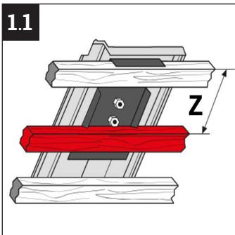
1.1 Zusatzlatte zur sicheren Lastabtragung einbauen. Lattmaß "Z" gemäß FLECK-Verlegehinweis beachten.
