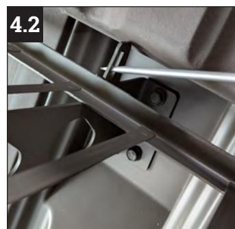
4.2 Dafür den Sicherungsbügel mit einem geeigneten Werkzeug (z.B. Schraubendreher) etwas nach oben biegen.
