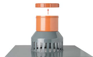
Gründachschacht: Schraubdeckel zur Sichtprüfung und Reinigung des Abflufs. Flansch aus robustem Hart-PVC
