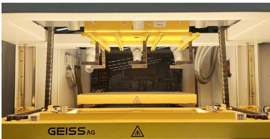
Neue Flash-Strahler heizen das Material schneller und effizienter auf.
